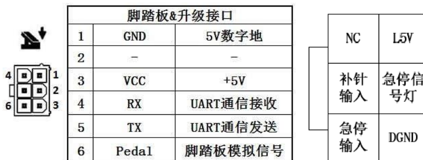
Рисунок 1-2-2. Соответствие разъемов блока управления
