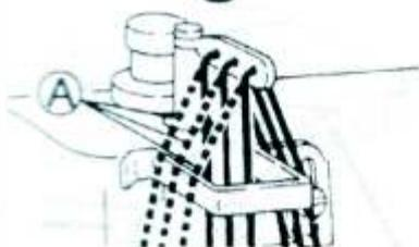
Пунктирными линиями (A) обозначена эластичная нить. Сплошной линией обозначена стандартная нить.
