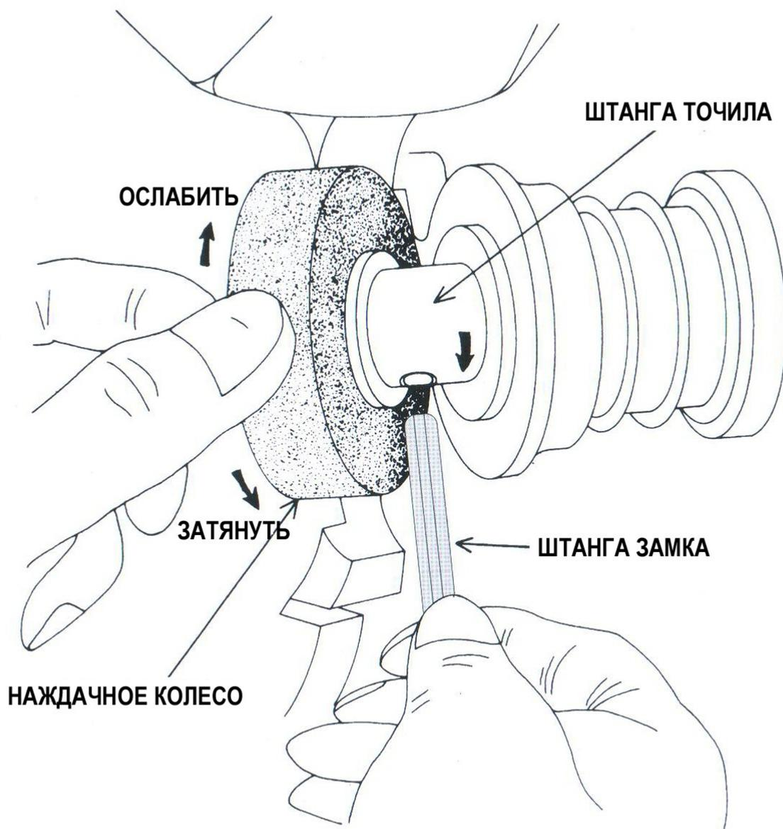
Придержите наждачное колесо рукой. Вложите прилагаемую штангу замка в отверстие в штанге точила и поверните в направлении, указанном стрелочкой. Удалите износившееся наждачное колесо и замените его новым.
